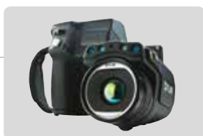
Integrierte 5 Megapixel Digitalkamera, LED-Lampen, Laserpointer, Okularjustierung, schwenkbares Objektiv, Bildaufzeichnungstaste und automatischer/manueller Fokus.
